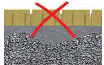
Grafik 3 Unebenheiten in der Tragschicht müssen vermieden werden
