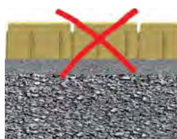
Grafik 8 Falsche Verlegung Steine dürfen nicht ohne Sollfuge verlegt werden
